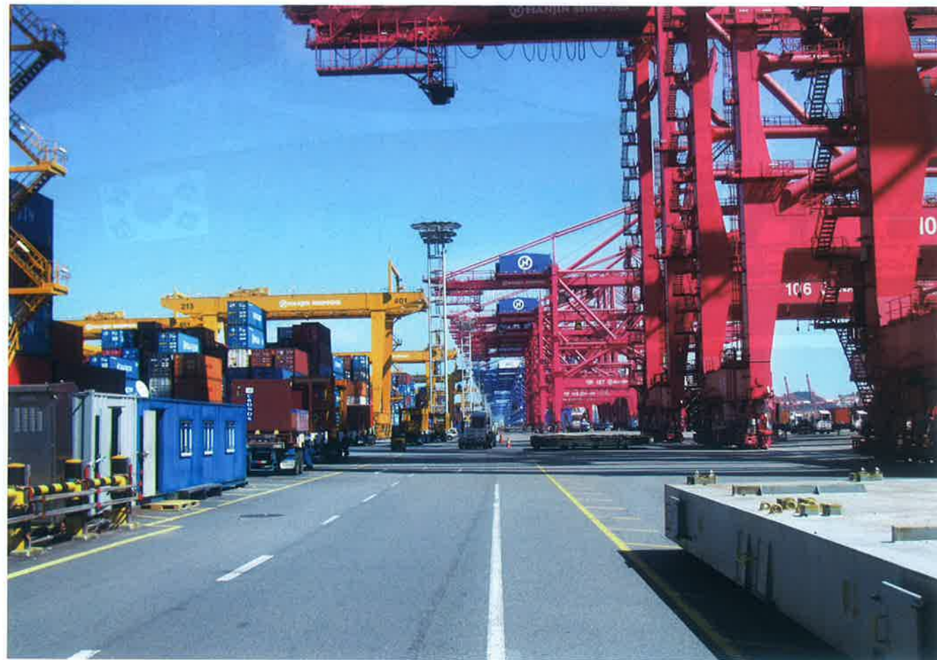
韓進海運新港湾の釜山新港コンテナターミナル。右側がガントリークレーン。左側がヤードクレーン。
